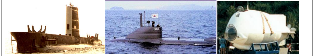
Britiske HMS Porpoise med vugger for små miniubåter, en tyskbygget Typ-70 (20 meter) i Sør-Korea og en italiensk 3GST9 (10 meter) med stort vindu i baugen og med tynt periskop (den militære versjonen var malt mørkegrøn).
